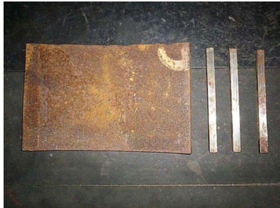
**Figura 4.3 - Corpos de prova oriundos dos cortes realizados nos tubos de aço API X70 na direção longitudinal.**
