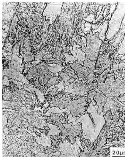
**Figura 3.18 - Ferrita quase-poligonal formada num aço de ultra-baixo carbono contendo 0,005% C e 3% Mn resfriado a 50°C/s (Krauss e Thompson, 1995).**
