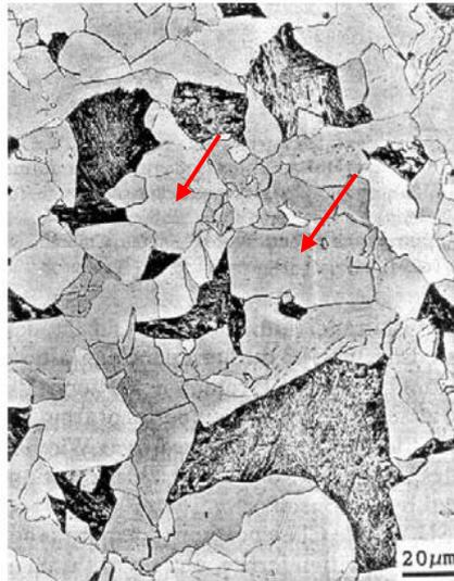
**Figura 3.16 - Ferrita poligonal (grãos claros) formada num aço HSLA-80 transformado isotermicamente a 675 °C por 500s. As regiões escuras correspondem à martensita formada na têmpera após o tratamento isotérmico a 675 °C (Krauss e Thompson, 1995).**
