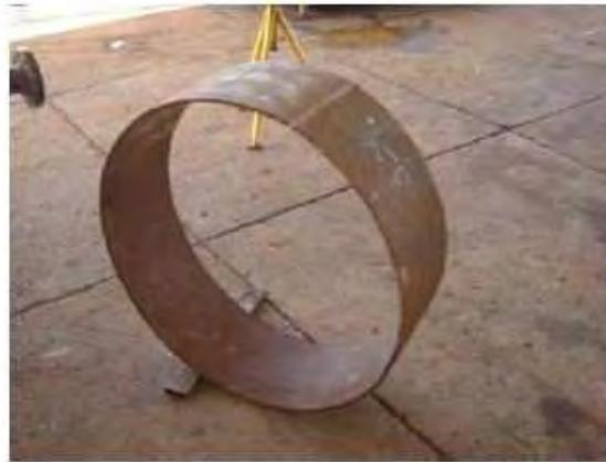
Figura 4.1 - Tubo API 5L X70 cedido pela Petrobrás.
