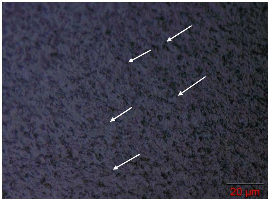
Figura 5.3 - Micrografia por MO produzida pela rota 3 (austenitização a 950°C + deformação de 15% + resfriamento em água à temperatura ambiente). 1000X.
