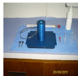
(f) Calibrador padrão de vazão PV 470 e manômetro de coluna d'água em forma de "U".
