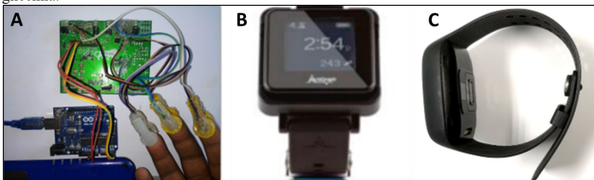
Figura 5 – Sensores não invasivos utilizados como fonte de dados em estudos de predição de glicemia.
