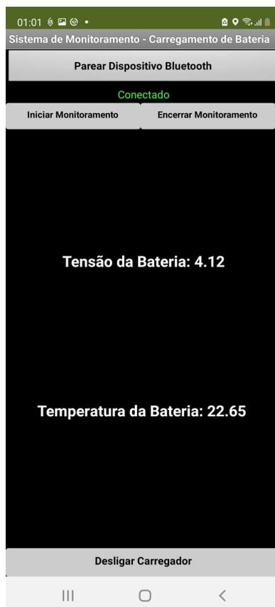
**Figura 5.2:** Dados dos sensores exibidos na tela do aplicativo de monitoramento (Fonte: O autor).
