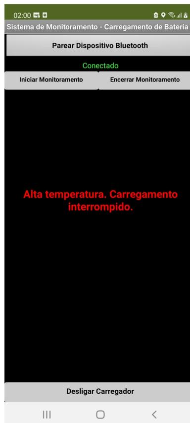
**Figura 5.10:** Mensagem exibida pelo aplicativo de monitoramento indicando detecção de sobre-temperatura (Fonte: O autor).
