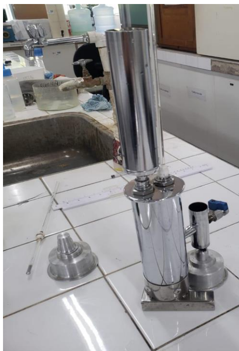
Figura 13 – Ebuliômetro com caldeira, lamparina e termômetro
