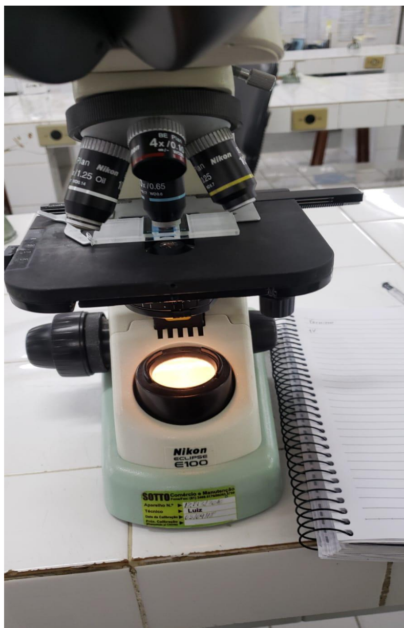
Figura 3 – Microscópio com a câmara de Neubauer acoplada
