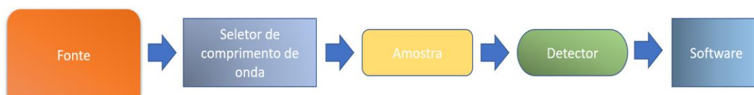
Figura 5 – Funcionamento simplificado de um espectrofotômetro UV-Vis
