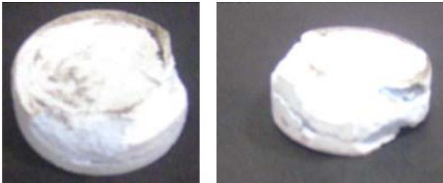
Figura 3.14 – Amostras de corpos de prova compostos de resíduo mais aditivo ADCER.
