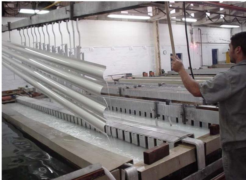
Figura 3.3 - Detalhe dos tanques de anodização. Fonte: Anodilux (2005).
