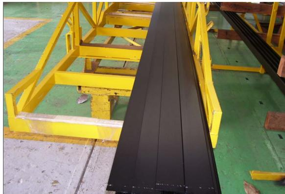
Figura 3.6 - Perfis metálicos anodizado. Fonte: Alcoa (2008).
