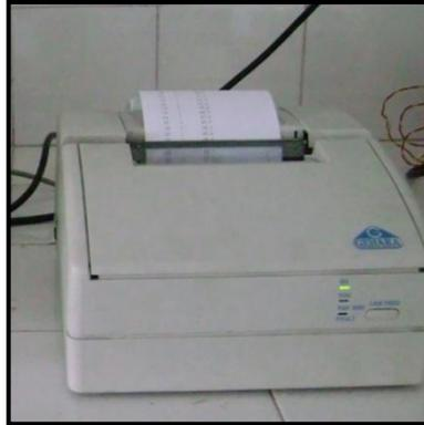
Figura 4.5 - Impressora do analisador de umidade por infravermelho
