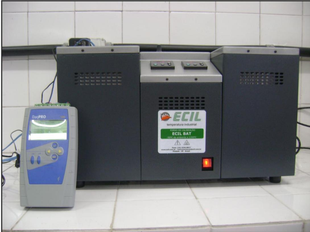
Figura A1.1 – Forno de calibração
