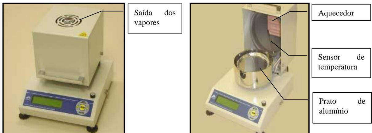
Figura 4.3 - Analisador de umidade por infravermelho
