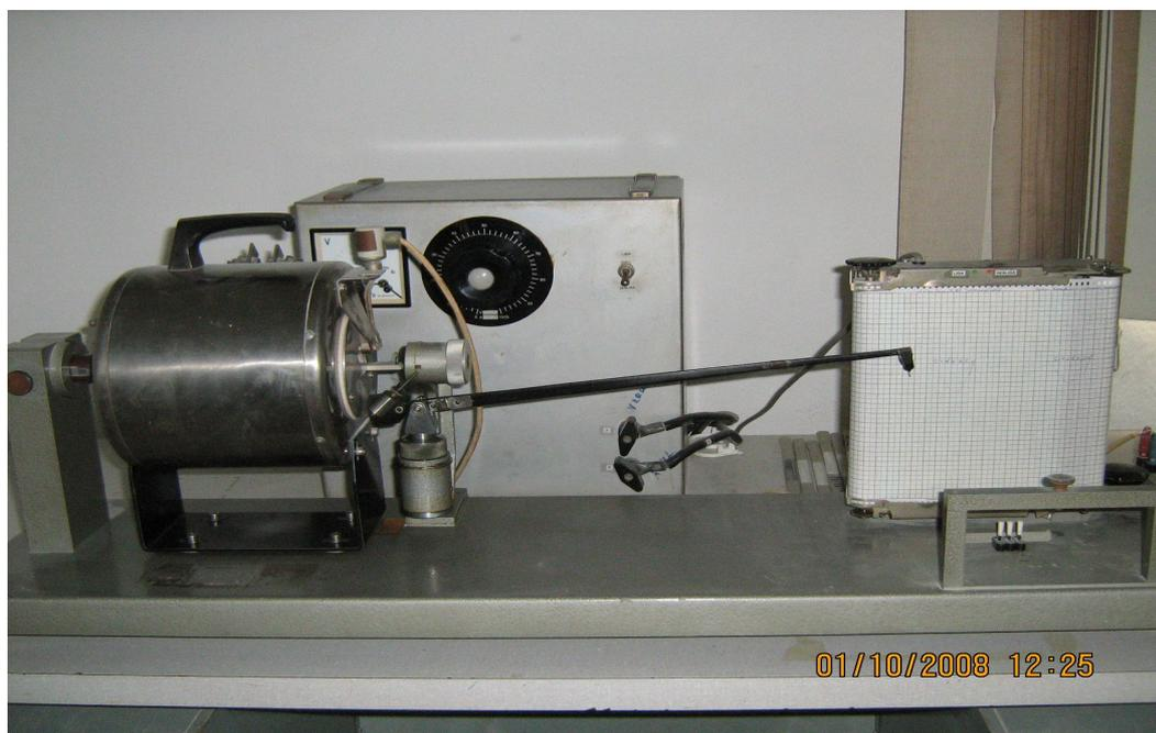
Figura 3.5 – Tensiômetro de Steger – Vista geral
