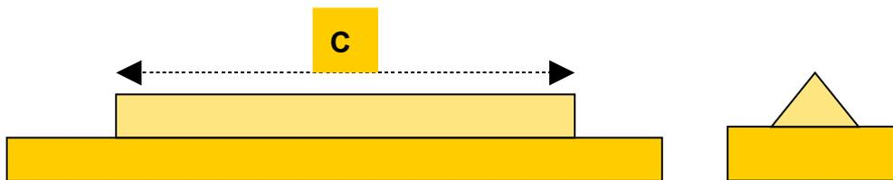
Figura 3.2 – Corpo de prova usado nos ensaios de retração, perda ao fogo e absorção.
