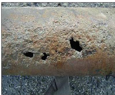
Figura 2.2 – Duto de aço com corrosão.<sup>2</sup>
