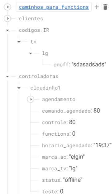
Figura 14 - Estrutura criada no Firebase Realtime Database
