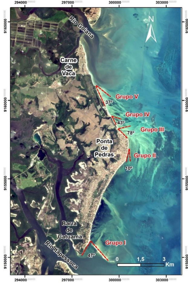
Figura 18 – Ângulo formado entre a crista da barra transversal e a linha de costa de um representante de cada grupo de barras transversais da área analisada. Grupo I localizado à sul e próximo à desembocadura do rio Itapessoca com ângulo médio de 47°, Grupo II na região central e quase paralelo à linha de costa (ângulo médio = 10°), Grupo III defronte ao obstáculo de Ponta de Pedras e formando ângulo quase perpendicular à linha de costa (ângulo médio = 78°), Grupo IV oblíquo à linha de costa (ângulo médio de 43°) e Grupo V a norte com ângulo médio de 37° e sob influência do canal do rio Goiana
