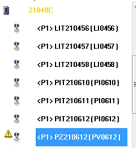
Figura 22 - Exemplo de Live List em sistema FOXBORO
