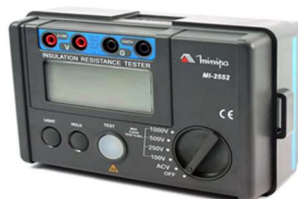
Figura 30 - Megômetro Minipa MI-2552.
