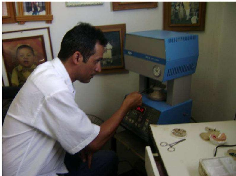
Fig. 3.12.3 Colocação das amostras no forno para queima
