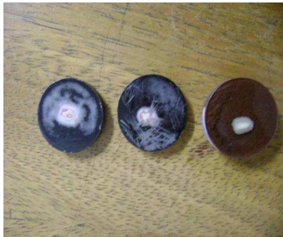
Figura 3.13 amostras de CMC,ADCER e PURA embutidas, pronta para ensaio de Microdureza.
