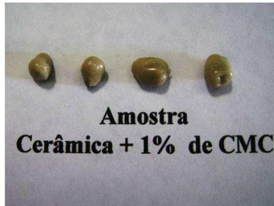
Fig.4.7.2 Amostra das próteses confeccionadas com 1% de CMC
