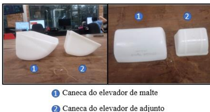
Figura 2 - Comparação entre as canecas dos elevadores de adjunto e malte
