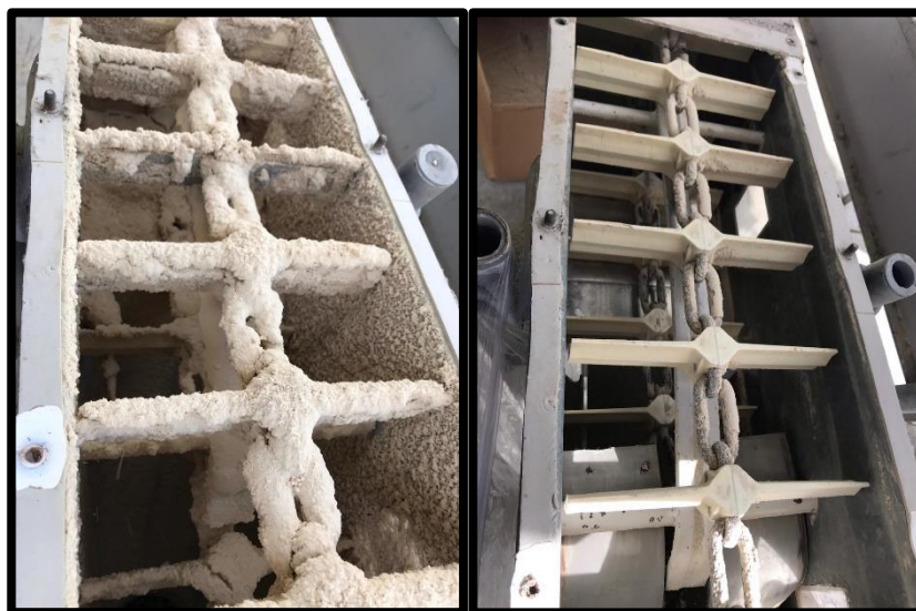
Figura 6 – Transporte de beneficiamento antes e após a limpeza com o raspador
