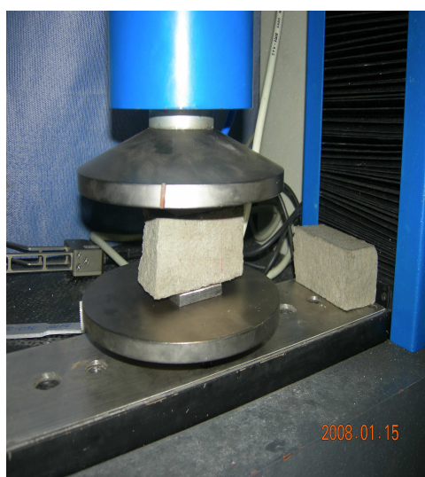
Figura 4.20 – Ensaio de compressão do grout quartzolit
