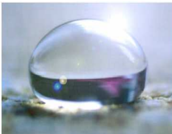
Figura 3.10 – Superfície de concreto com filme ultrafino hidrofóbico. [20]
