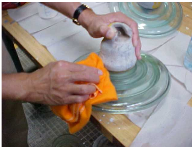
Figura 3.11 – Aplicação do filme ultrafino hidrofóbico.
