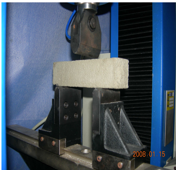
Figura 4.18 – Ensaio de flexão três pontos do grout quartzolit.
