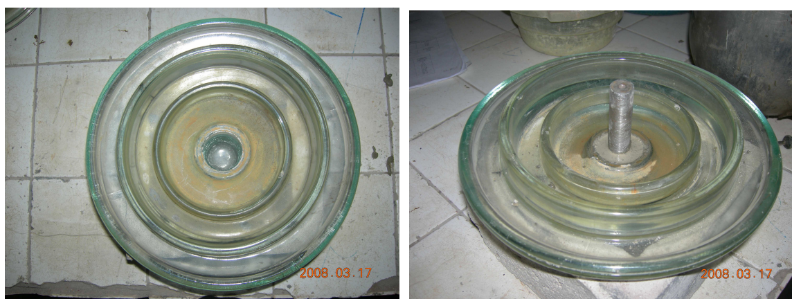
Figura 3.7 – Isolador de vidro sem pino e com pino para ensaio de tração.
