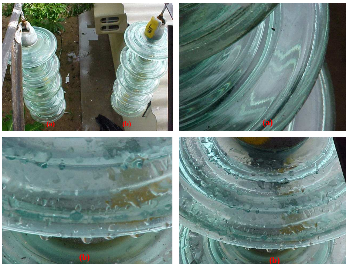
Figura 4.24 – Cadeia de isoladores após 60 dias sem o filme (a); e com o filme (b).
