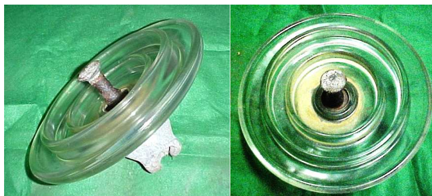
Figura 1.2 - Isolador de vidro com o pino metálico que sofreu corrosão.
