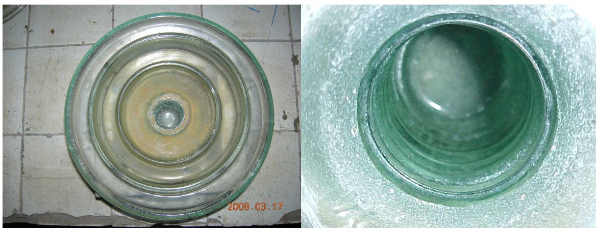
Figura 4.9 - Isolador de vidro sem pino metálico que sofreu corrosão.
