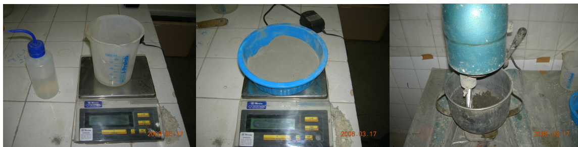
Figura 3.3 – Preparação da argamassa.
