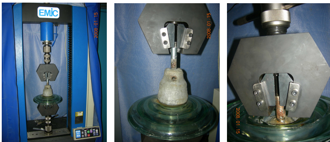
Figura 4.16 – Ensaio de tração da fixação do pino com argamassa quartzolit.
