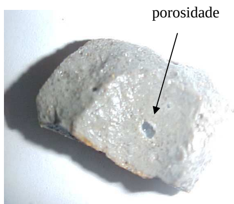
Figura 4.1 – Fotografia da argamassa retirada de um isolador de vidro de alta tensão.
