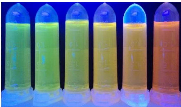
Figura 5 - Pontos quânticos de CdTe aquecidos de 0,5 h a 3 h sob excitação à luz UV \lambda_{exc} = 365 nm).
