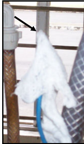
Figura 4.16 – Termopar para medição da temperatura de bulbo úmido (TBU).
