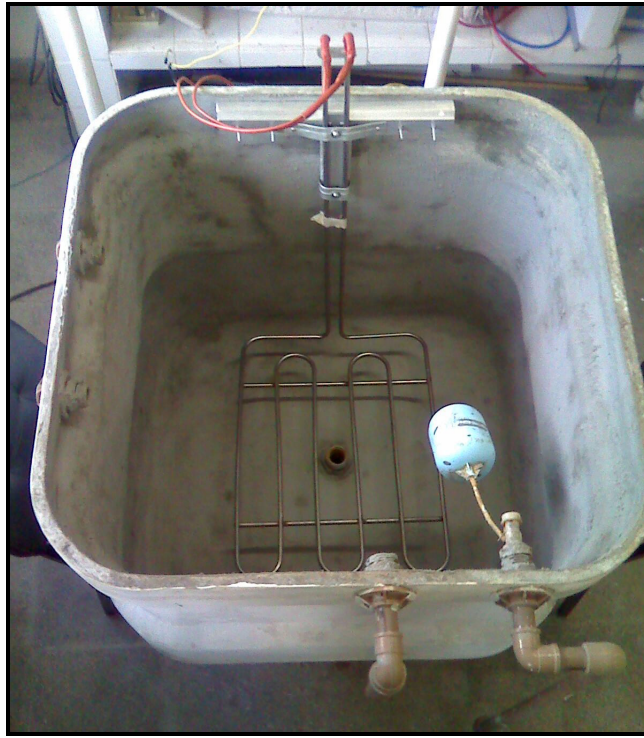
Figura 4.23 – Resistência elétrica para aquecimento d'água.
