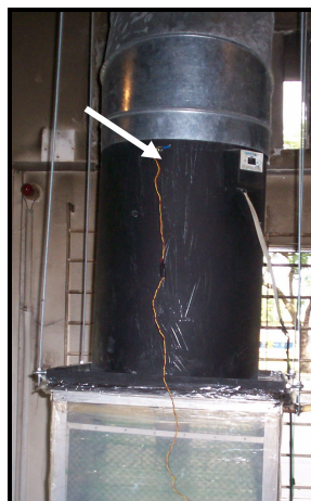
Figura 4.18 – Termopar tipo K para medição do ar de exaustão.
