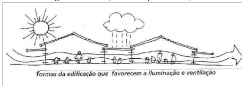
Figura 72 - Ilustração iluminação e ventilação
