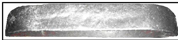
Figura 3.1- Lingote de ligas de alumínio do sistema AlSiCu.
