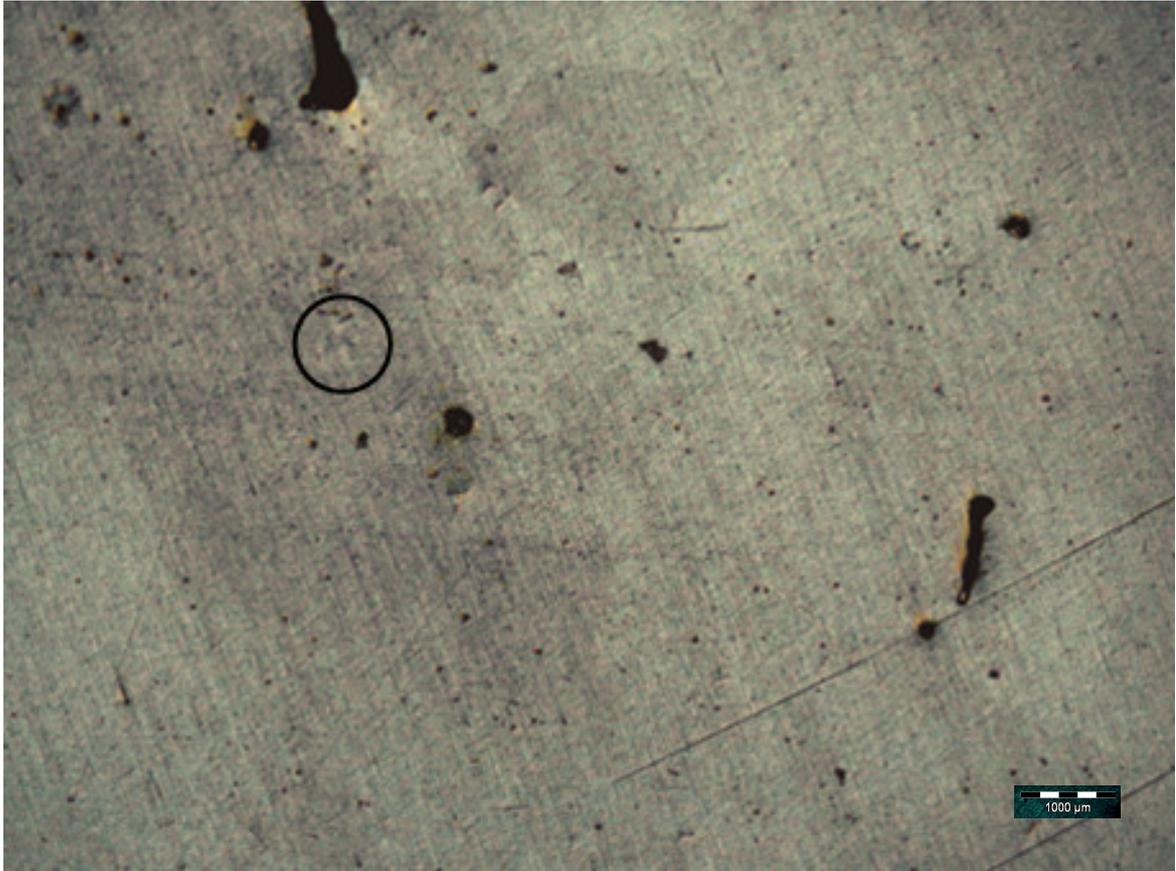
Figura 4.6- Microestrutura da liga Al-1,5%Si-1,0%Cu tratada a 120°C por 60 minutos
