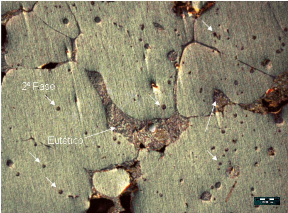
Figura 4.17. Microestrutura da liga com 2,5%Si deformada 20% e tratada a 150°C por 15min.
