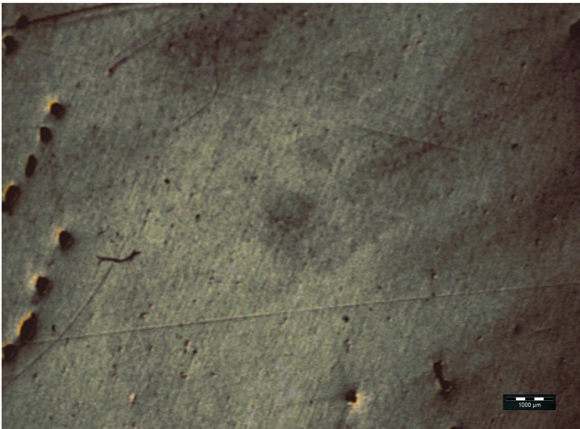
Figura 4.5- Microestrutura da liga Al-1,5%Si-1,0%Cu tratada a 120°C por 5 minutos
