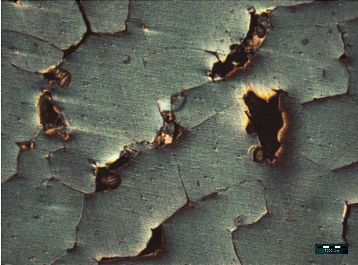
Figura 4.12- Microestrutura da liga com 1,5%Si deformada 20% e tratada a 150°C por 60min.
