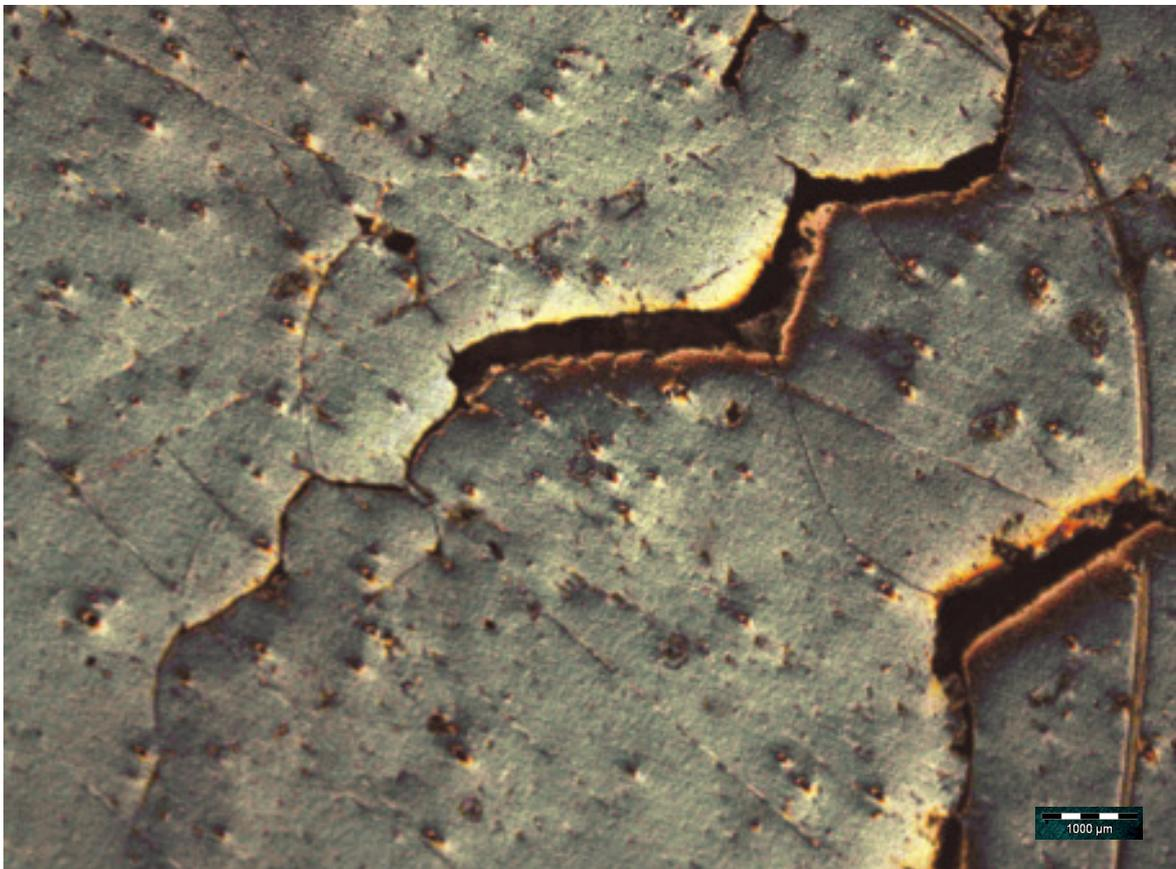
Figura 4.10- Liga com 1,5%Si deformada 20% e tratada a 120°C, por 15min.
