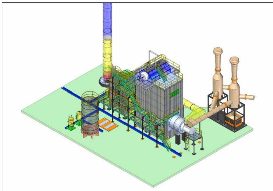
Figura 4-19. Gerador de vapor em vista tridimensional
