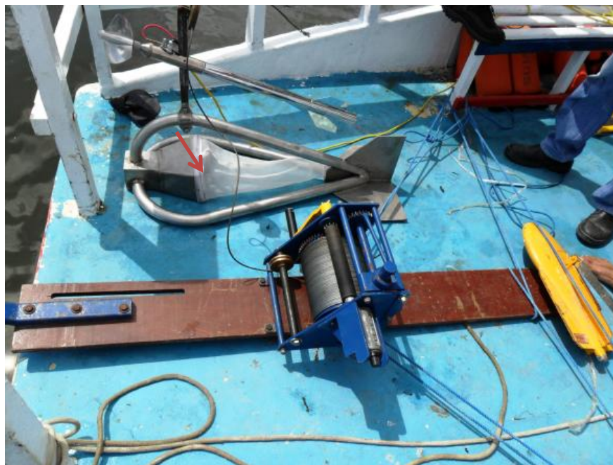
Figura 84. Saco de coleta de amostra ,seta em destaque, responsável por acumular sedimentos
