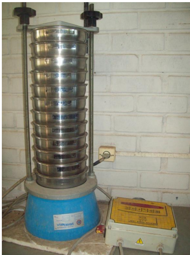
Figura 56. Agitador eletromagnético usado na classificação das amostras coletadas no Rio Timbó em 20/01/2011
