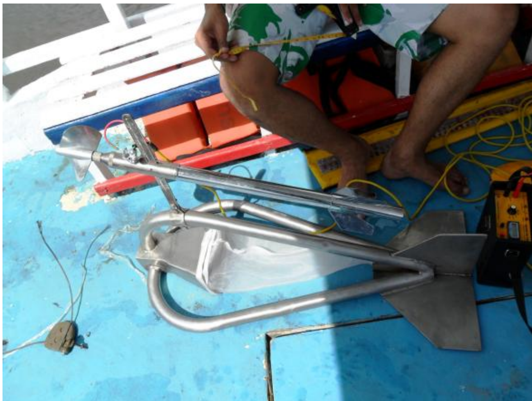
Figura 52. Acoplamento do molinete de medir velocidade, preso à haste na parte superior, e ao amostrador
