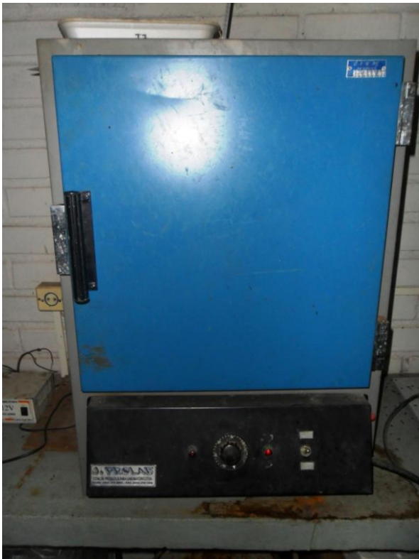
Figura 55. Estufa de secagem j.Prolab usada secagem das amostras do Timbó.
