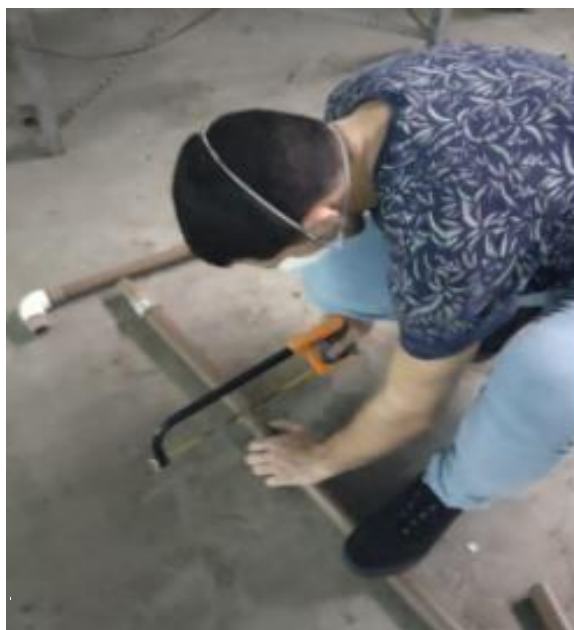
Figura 17 – Cortes dos tubos
