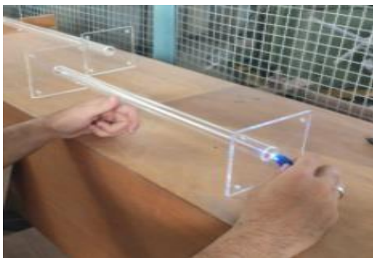
Figura 16 – Fixação da flange com o tubo de acrílico
