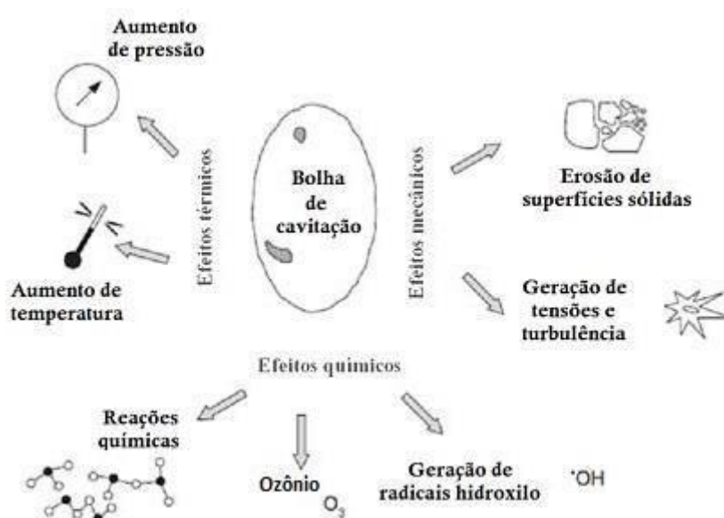
Figura 8 – Efeito da cavitação térmicos, químicos, mecânicos ou físicos.
