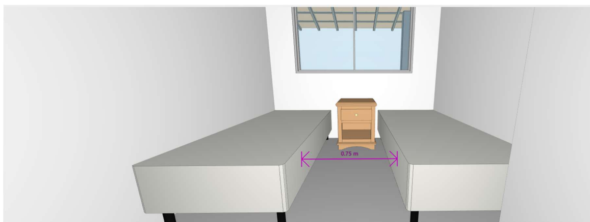
Figura 38 – Inconformidade do item de acessibilidade 10.9.3 da NBR 9050 no DAC
