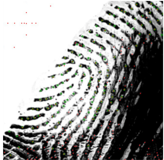
(b) Imagem 7 com a detecção dos poros pela CNN antes da etapa de refinamento.
