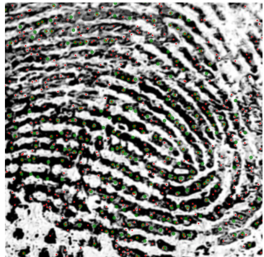
(b) Imagem 2 com a detecção dos poros pela CNN antes da etapa de refinamento.
