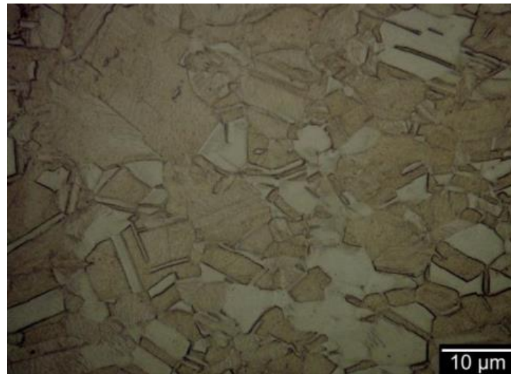
Figura 4 - Micrografia de latão 70/30.
