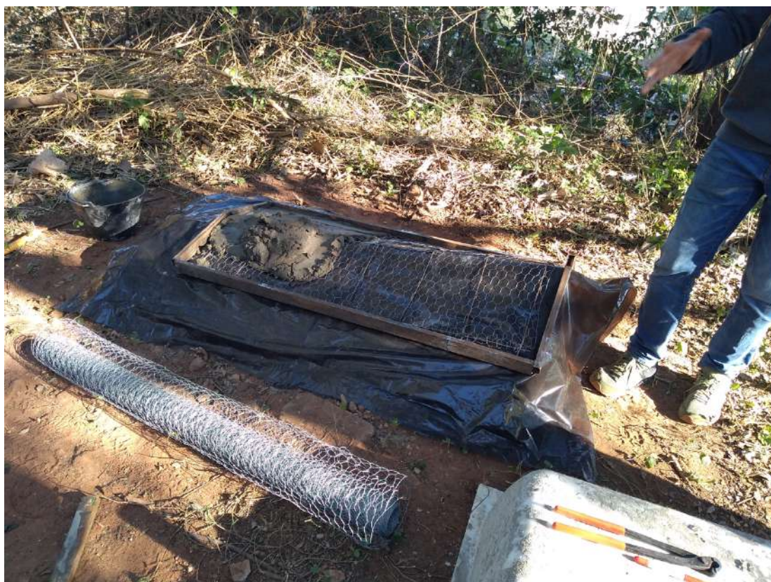
Figura 32: Ensaio com materiais. Casca em argamassa armada com tela metálica de galinheiro. Assunção, Paraguai
