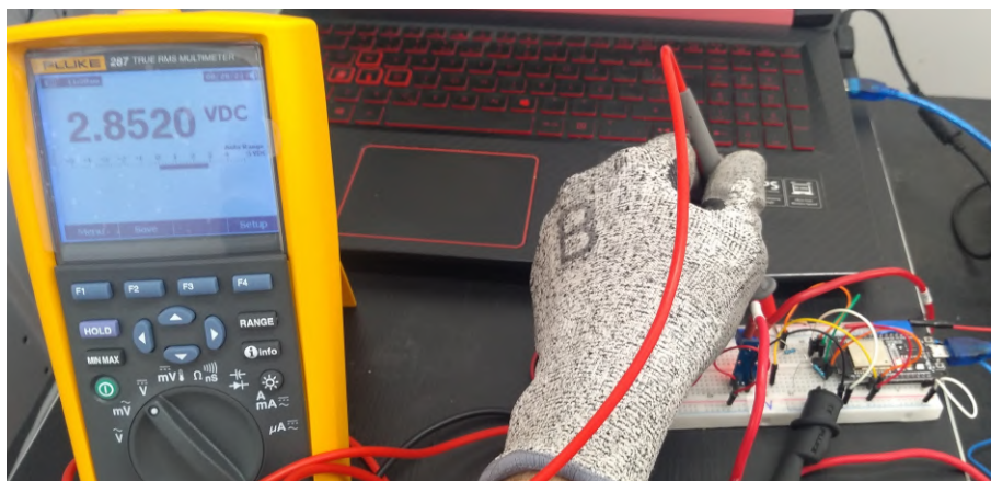
Figura 3.34: Tensão de entrada referente ao divisor de tensão (Fonte: o autor).
