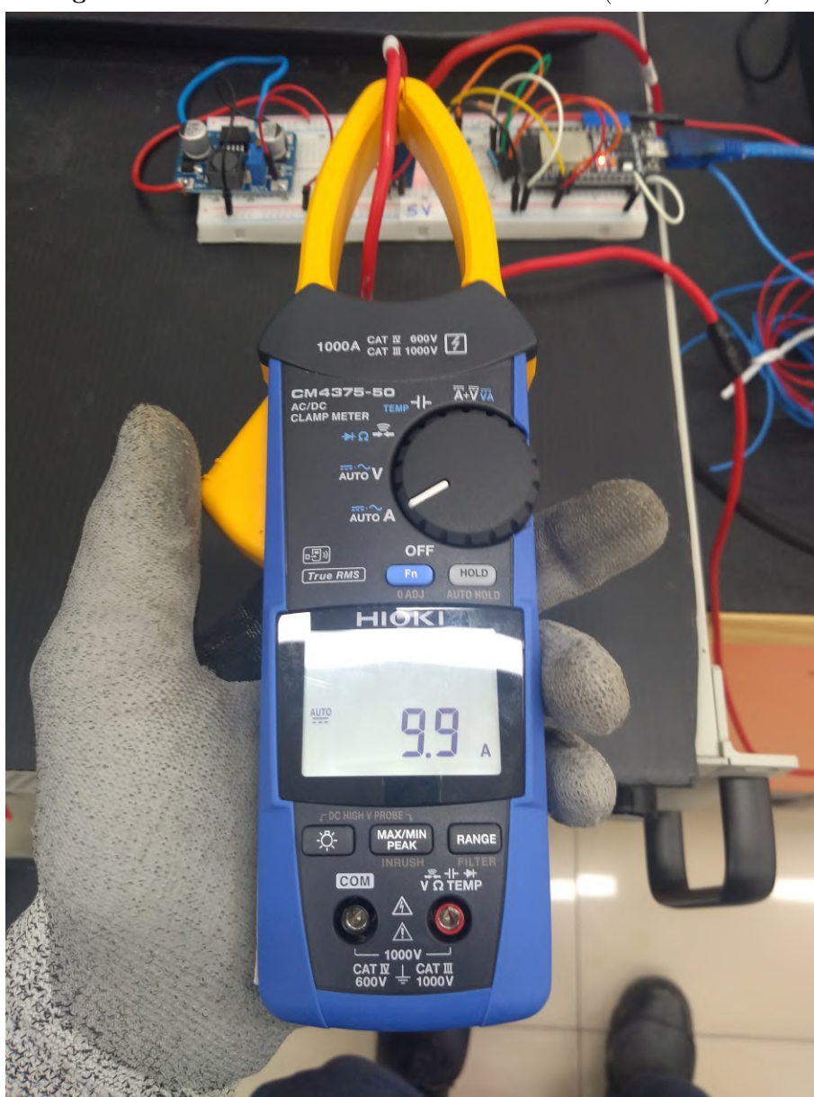
Figura 3.33: Corrente elétrica de recarga (10 A) (Fonte: o autor).
