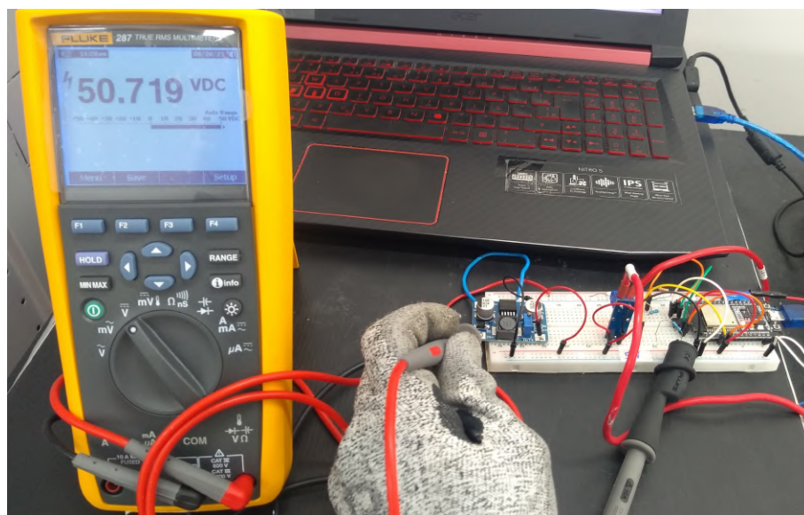
Figura 3.31: Tensão da bateria que chega aos terminais de entrada do conversor DC-DC (Fonte: o autor).
