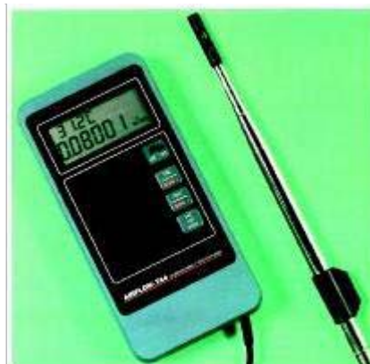
Figura 5.5 – Termo-anemômetro de fio quente AIRFLOW TA-4.
