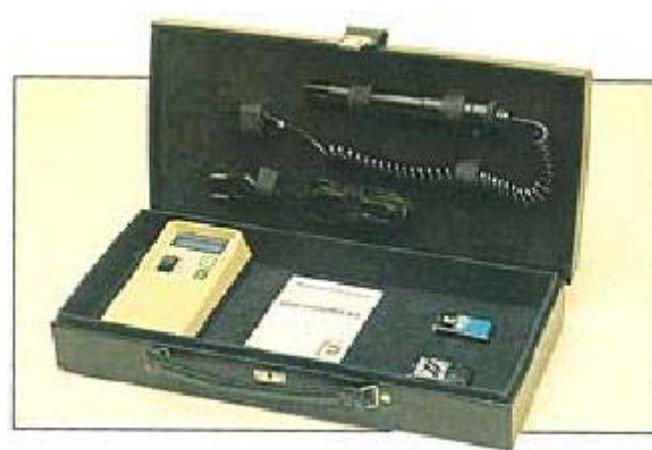
Figura 5.15 – Instrumento portátil para medição de umidade relativa e temperatura ambiente, marca IOPE, modelo IOPHYGRO 51.
