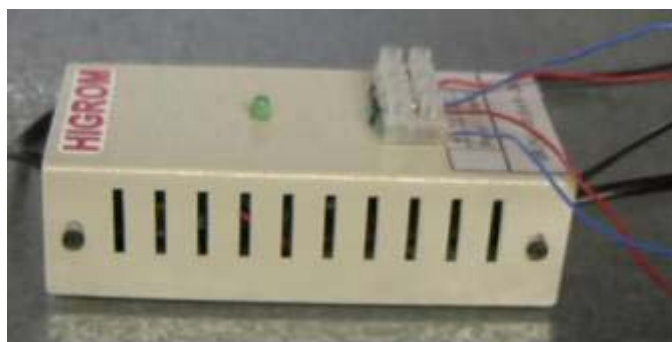
Figura 5.14 – Sensor de umidade do tipo capacitivo desenvolvido pela UFSC – Florianópolis.
