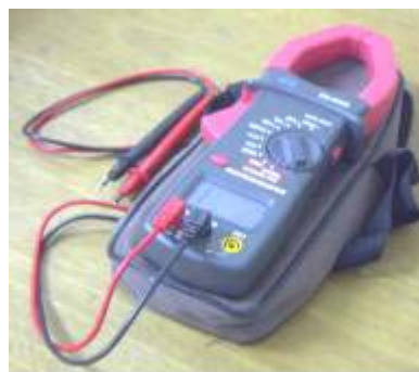
Figura 5.4 – Alicate amperímetro, marca ICEL – Modelo AD-9030.
