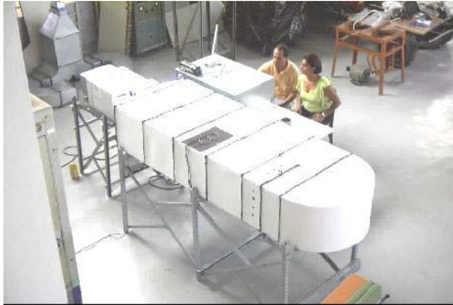
Figura 3.1 – Túnel de Ensaio Climatizador em forma de “U” para unidade condicionadora de ar tipo janela (DEMEC-UFPE).
