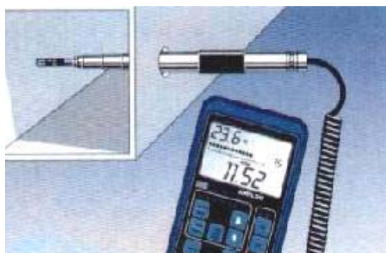
Figura 5.7 – Forma de medição da velocidade em duto.
