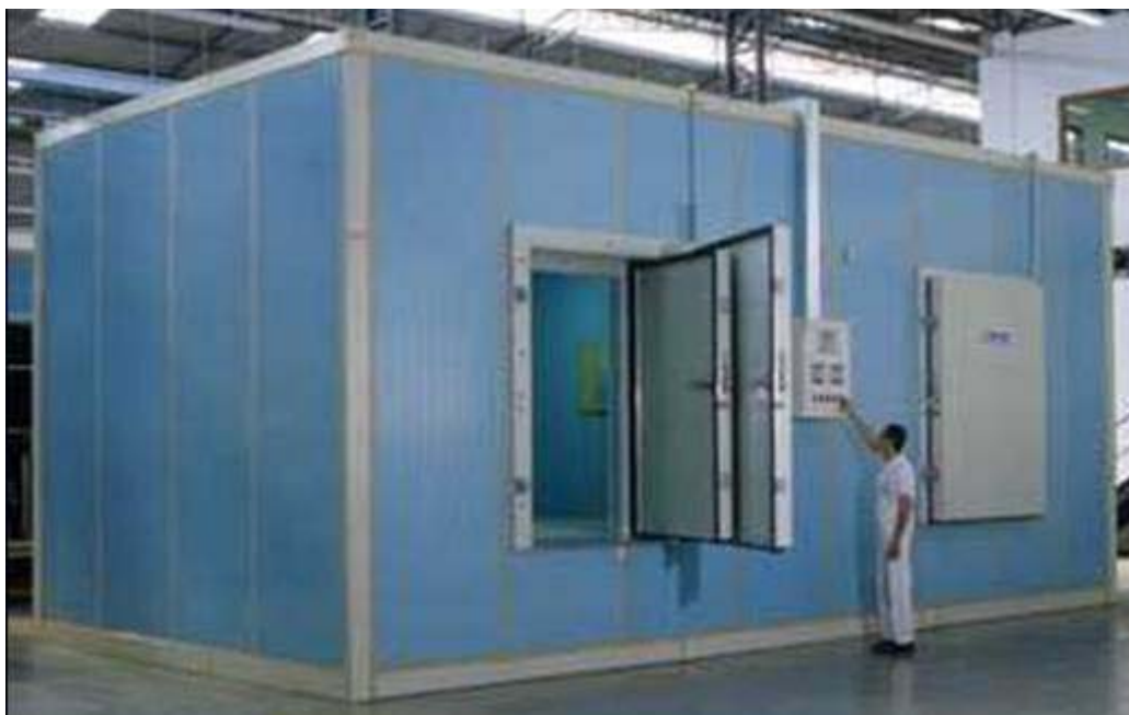
Figura 1.1 – Vista externa do calorímetro do tipo calibrado e de ambiente balanceado 1 , marca MECALOR [4] .
