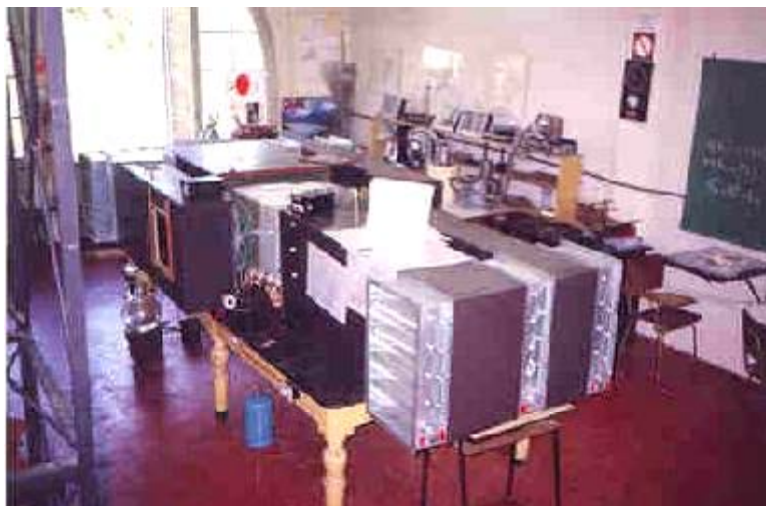
Figura 1.3 – Calorímetro do tipo psicrométrico 2 desenvolvido pelo Laboratório de Vapor e Refrigeração - LAFRIG, construído pela UFRGS [6] .
