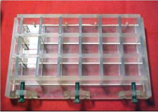
Figura 3.2 – Moldes para a fabricação de blocos para os ensaios de compressão
