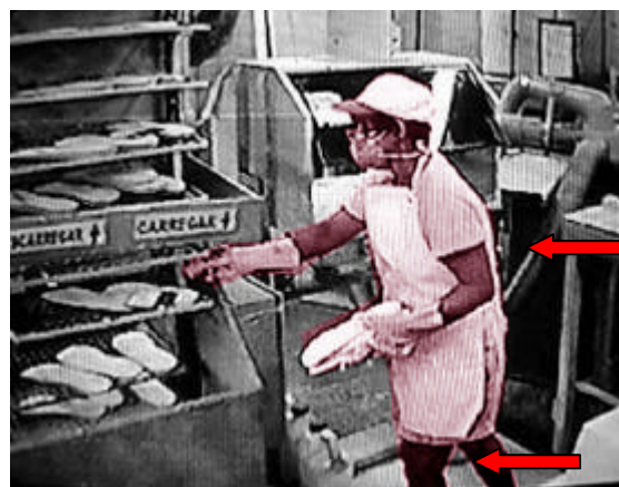
Figura 38: Posturas 9 e 10, colocar o material já untado de cola, no pinheiro de secagem.
