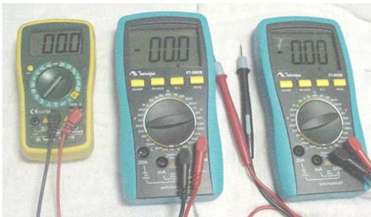
Figura 3.13 – Multímetros digitais usados nas medições de tensão corrente e frequência por ocasião dos experimentos.
