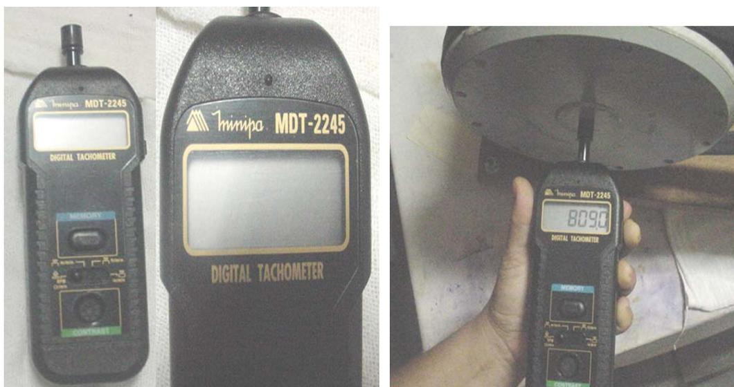
Figuras 3.12a e 3.12b – Tacômetro usado para medição das rotações da Turbina.
