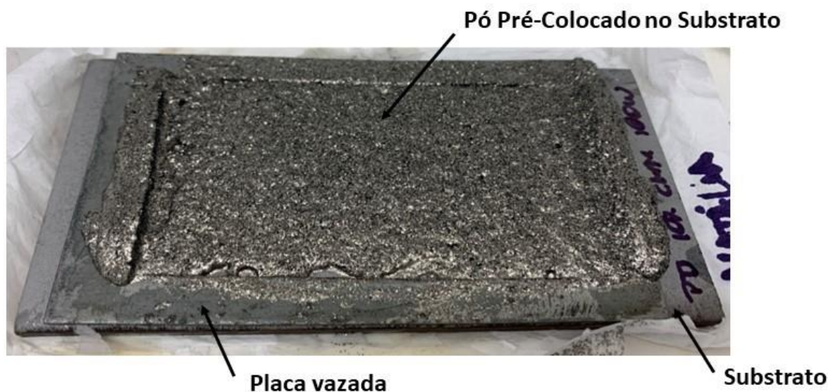
Figura 18 – Pré-colocação dos pós compósitos no substrato para posterior processamento por laser
