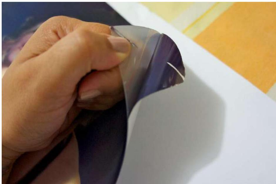
Figura 106 – Substrato Lenticular de origem industrial chinesa. Fonte: elaborado pela autora (2020).
