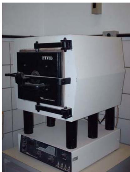
Figura 3.9 – Forno para tratamento térmico.
