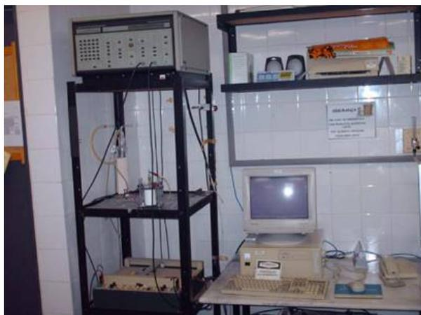
Figura 3.8 – Potenciostato para realização de ensaio de corrosão.
