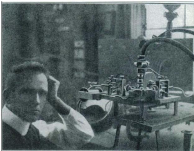
Figura 2.3.3 – Dr. Schoop in 1914 e seu primeiro dispositivo de aspersão térmica operada eletricamente, adaptado de [12].
