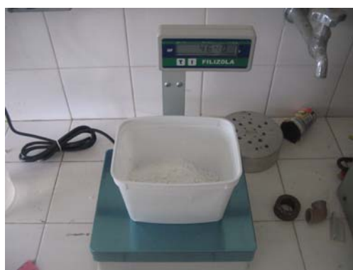
Figura 5.2 – Medição do pó de gesso em balança digital
