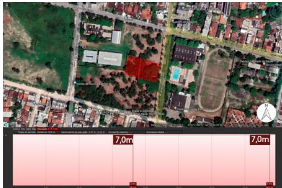
Figura 26 - Corte topográfico transversal do terreno
