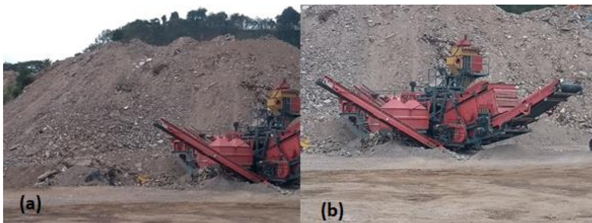
Figura 24. Pilha de resíduo da construção e demolição no aterro e britador utilizado para produção do agregado reciclado.
