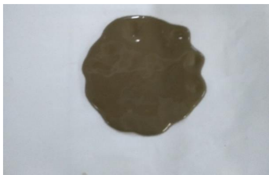
Figura 34. PRH após ensaio de absorção de água (escala 1:5)
