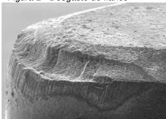
Figura 2 - Desgaste de flanco
