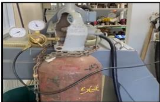
Figura 6 – Adaptação para injeção do argônio: (a) Cilindro de gás; (b) Injeção na interface
