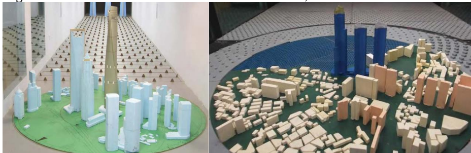
Figura 6 – Análise estrutural através de modelos físicos, o túnel de vento
