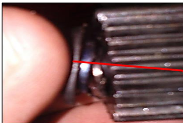
Figura 5.3. Desalinhamento do eixo suporte, direção destacada em vermelho, em relação à engrenagem.
