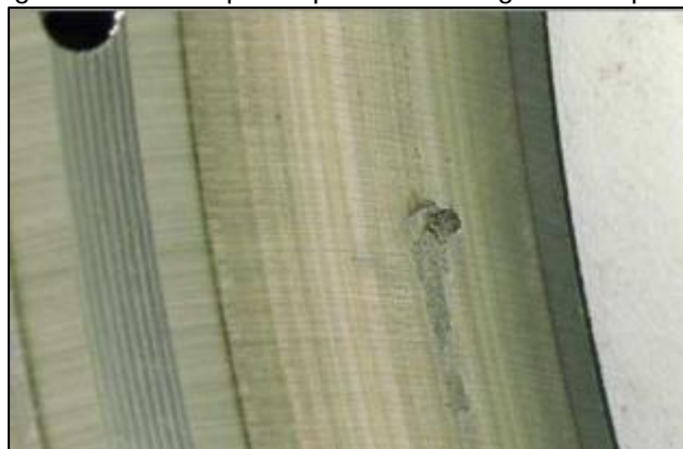
Figura 3.15. Exemplo de padrão de desgaste das pistas.
