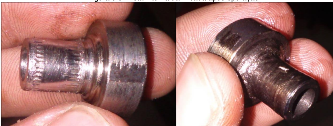
Figura 5.5. Pista interna danificada após operação.
