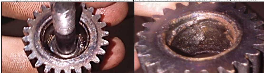
Figura 5.4. Rolamento do conjunto satélite quebrado. Detalhe da pista externa, à direita.
