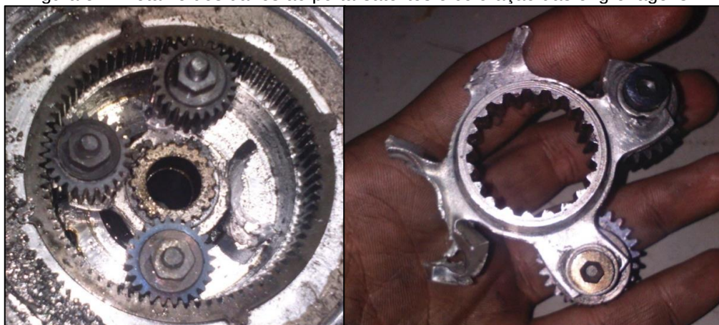
Figura 5.1. Detalhe dos danos ao porta-satélites e coloração das engrenagens.
