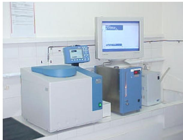
**FIGURA 4.2: Calorímetro utilizado no GET/UFPE, modelo IKA - C 2000 BASIC.**
