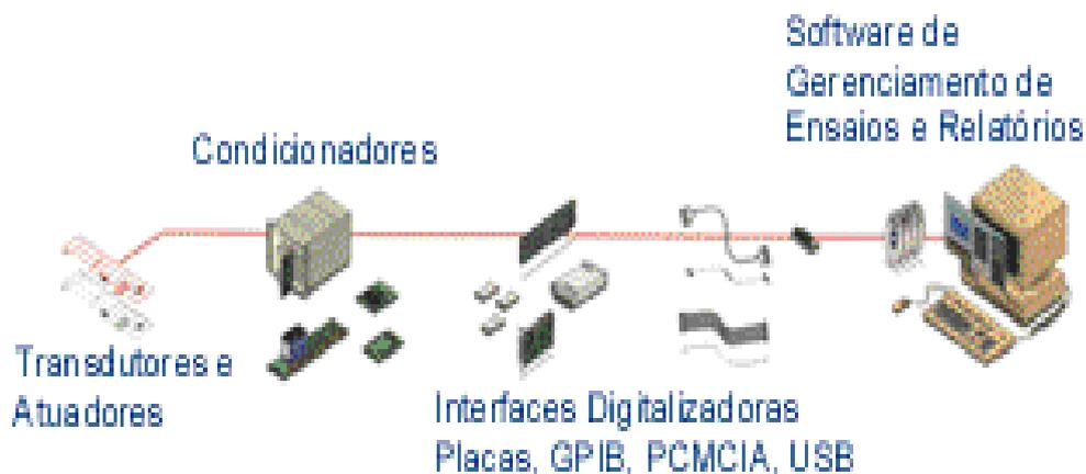
**FIGURA 4.14 - Sistema de Funcionamento da Aquisição de dados**
