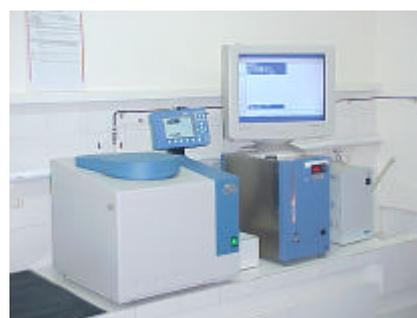
**ENSAIO NO CALORÍMETRO**
