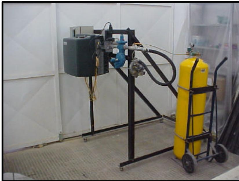
**FIGURA 4.7 - Esquema físico do Queimador e do Cilindro de GNV**
