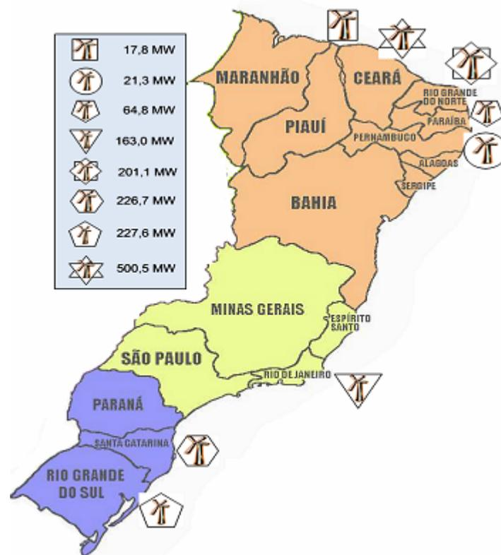
Figura 1.5: Capacidade Instalada de energia eólica até 2008 no Brasil.
