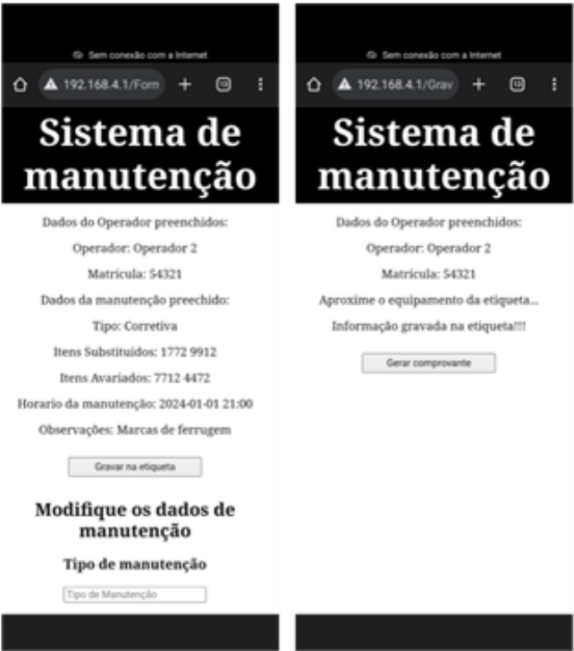
Figura 31. Sequência de telas à função: gravação da última manutenção.
