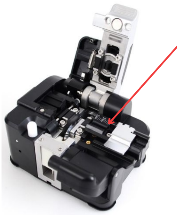
Figura C.1: Indicação do v-groove no clivador
