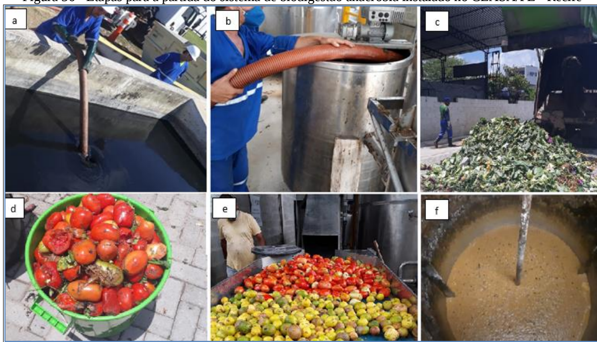
Figura 36 - Etapas para a partida do sistema de biodigestão anaeróbia instalado no CEASA/PE - Recife
