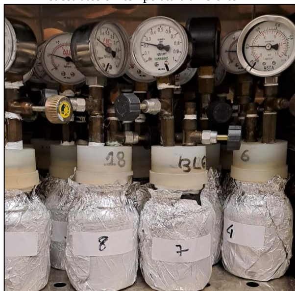
Figura 30 - Biorreatores com diferentes inóculos e substratos em temperatura ambiente
