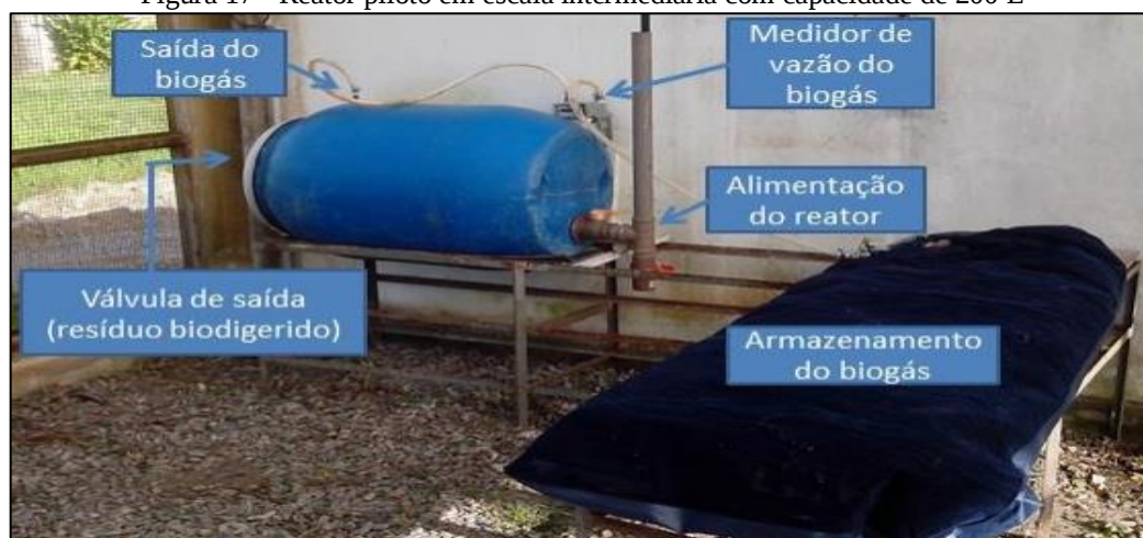
Figura 17 - Reator piloto em escala intermediária com capacidade de 200 L
