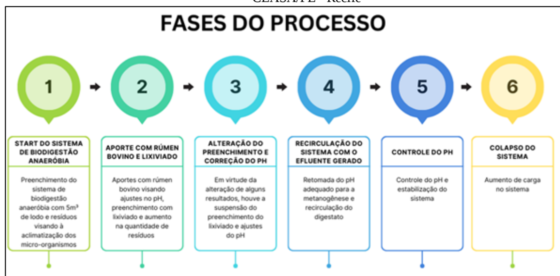
Figura 54 - Diferentes fases do processo do sistema de biodigestão anaeróbia instalado nas dependências do CEASA/PE - Recife
