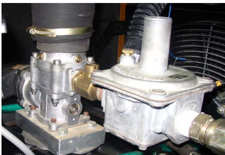
Figura 2.5 – Regulador de Pressão
