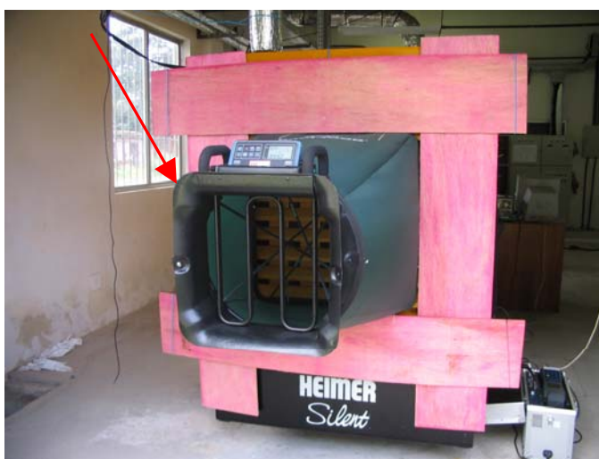
Figura 3.11 – Balômetro montado no grupo gerador
