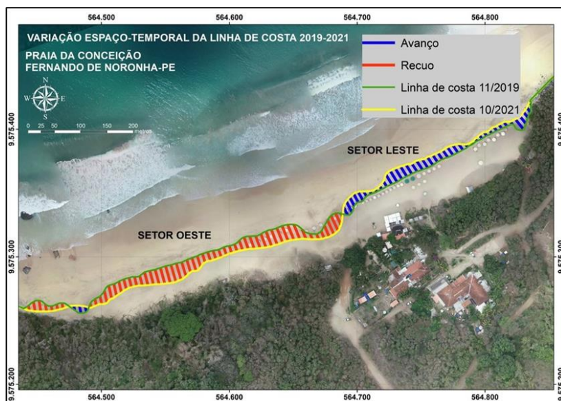
Figura 57 – Mapa do deslocamento da linha de costa da Praia da Conceição (2019-2021). A cor vermelha representa o setor localizado a oeste, destacando um processo erosivo. A cor azul representa o setor leste destacando a deposição de sedimentos.
