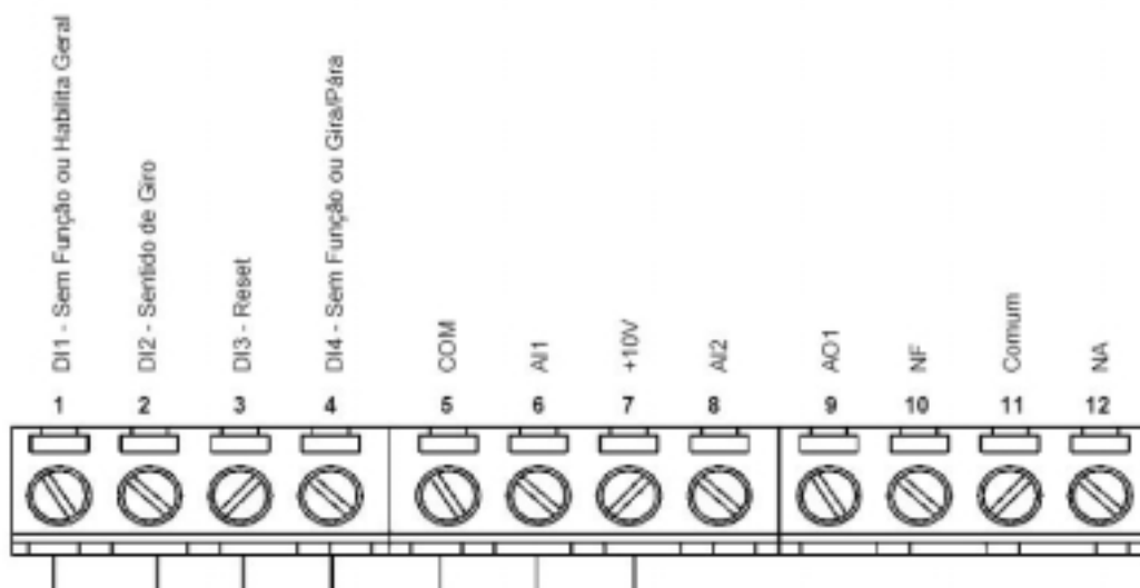
Figura 5.2 – Esquema retirado do manual do Inversor de frequência CFW08, mostrando o inversor de frequência e os pontos de ligações de controle, energia e aterramento.
