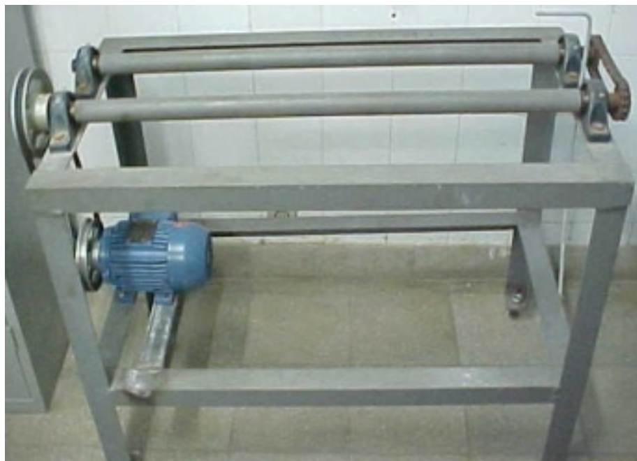
Figura 6.1 – Foto da mesa confeccionada para os ensaios com o moinho de bolas
