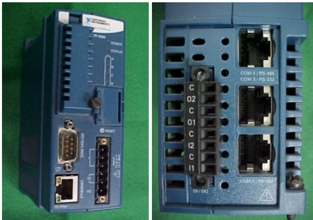
Figura 5.13 – Controlador Compact Fieldpoint cFP-2020, vista superior (à esquerda); e vista lateral com as conexões em detalhe (à direita).
