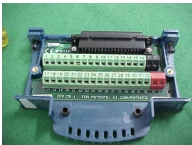
Figura 5.18 – Módulo cFP-CB-1, módulo aberto mostrando as conexões físicas.
