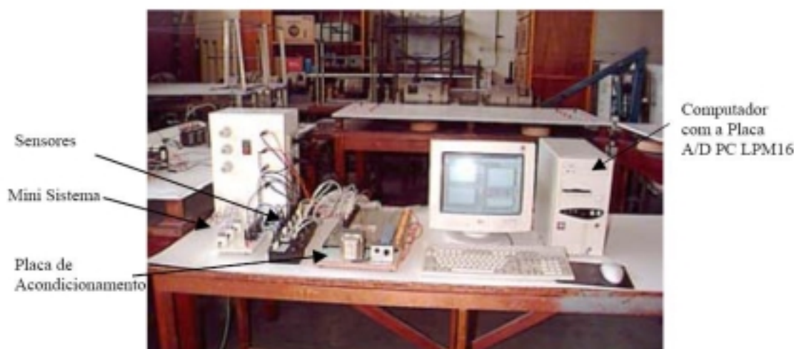
Figura 2.4 – Foto do sistema completo com sensores, placa de condicionamento de sinais e micro PC com placa A/D. [9]
