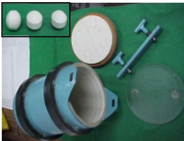
Figuras 5.5 - Componentes do moinho de bolas: esferas (ou bolas), moinho de bolas (cilindro, tampa e trava da tampa) e tampa transparente de policarbonato.
