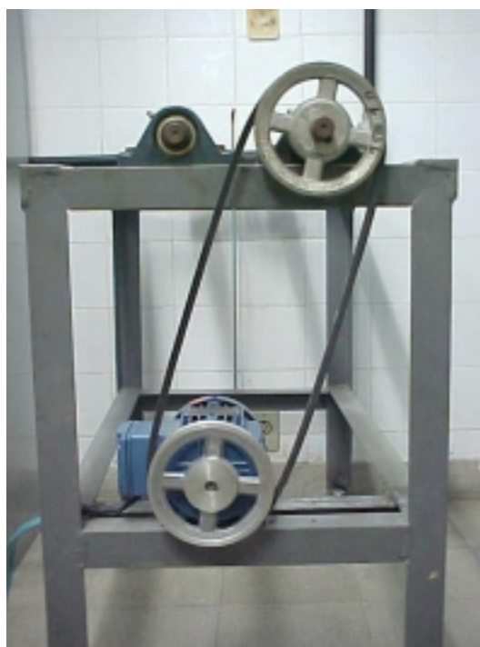
Figura 6.2 – Foto da mesa para execução dos ensaios de moagem mostrando em destaque as polias para transmissão de movimento.
