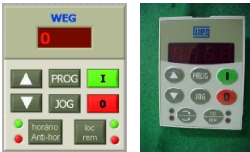
Figura 6.7 – Painel Virtual gerado em programação LabVIEW (à esquerda) simulando o painel original (físico) do CFW-08 (à direita).
