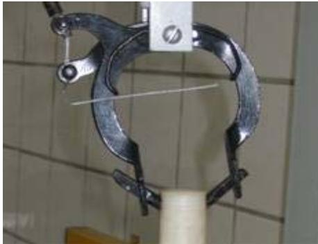
Figura 5.7- Garra mecânica para levantamento e disparo de embalagens
