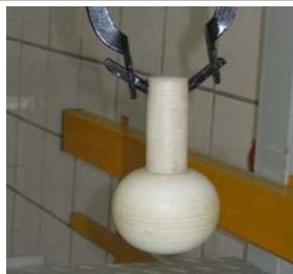
Figura 5. 6- Dispositivo padronizado para levantamento disparo de embalagens.
