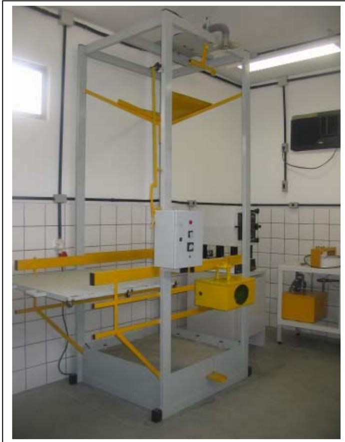
Figura 5.1 – Fotografia do equipamento para ensaios em embalagens plásticas flexíveis segundo a NBR 9191.
