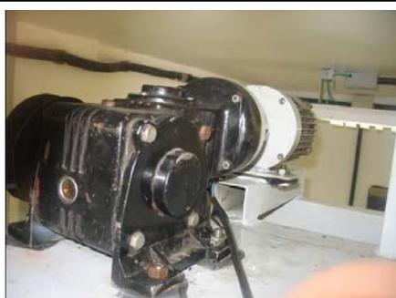
Figura 5. 5- Redutor mecânico de velocidades.
