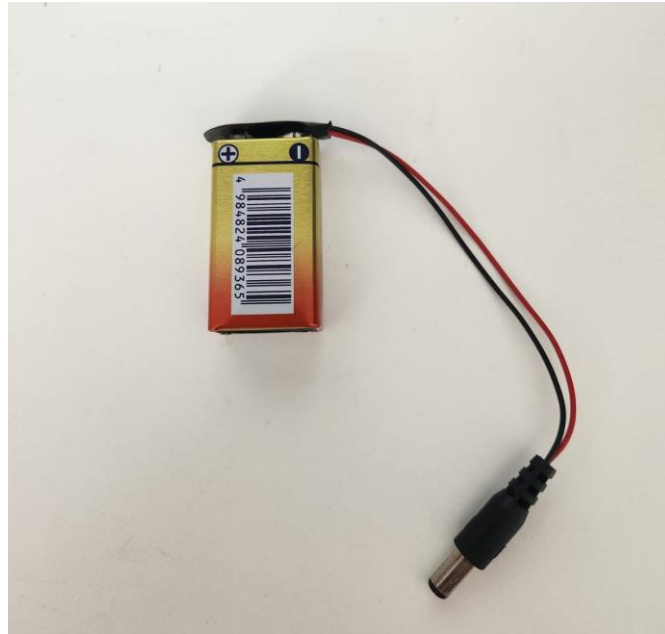
Figura 13 - Configuração bateria adaptador para alimentar o sistema
