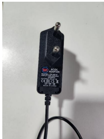
Figura 11 - Fonte de alimentação 9V-1A
